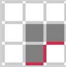
La sélection des segments permet de déterminer la position des angles et le sens des tôles.
